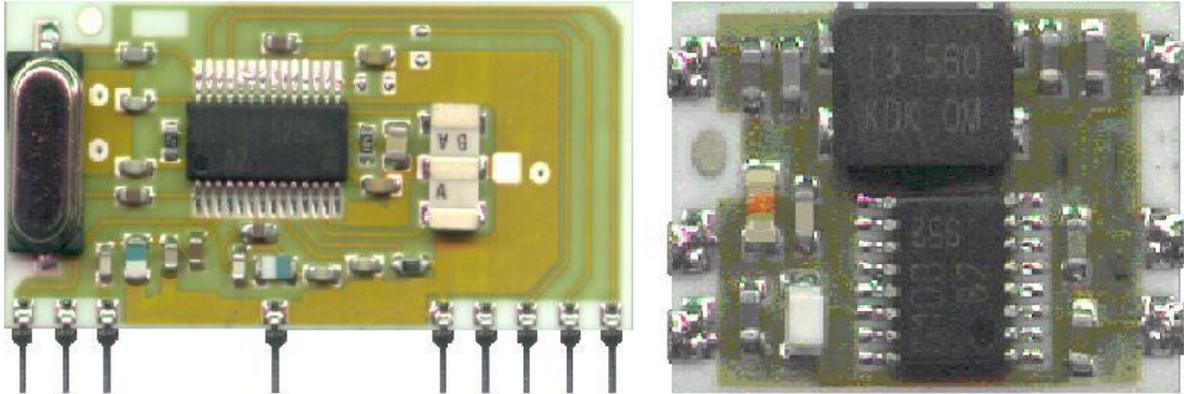
Fig 6 : RRFQ1 and RTFQ1 [ 866 MHz } Rx ,Tx modules.
