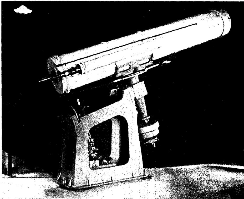
Fig. 3 20-inch Grubb Reflector
