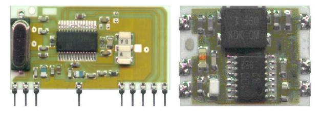
Fig 6 : RRFQ1 and RTFQ1 [ 866 MHz } Rx ,Tx modules.
