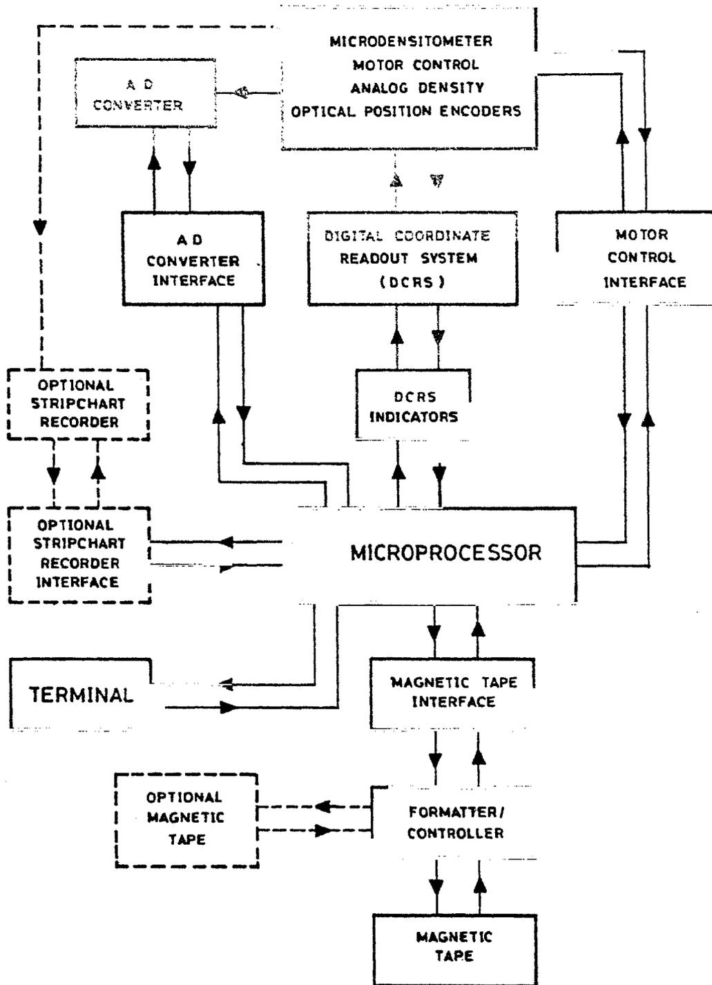
FIG.1 - THE MICRO-10 SYSTEM BLOCK DIAGRAM
