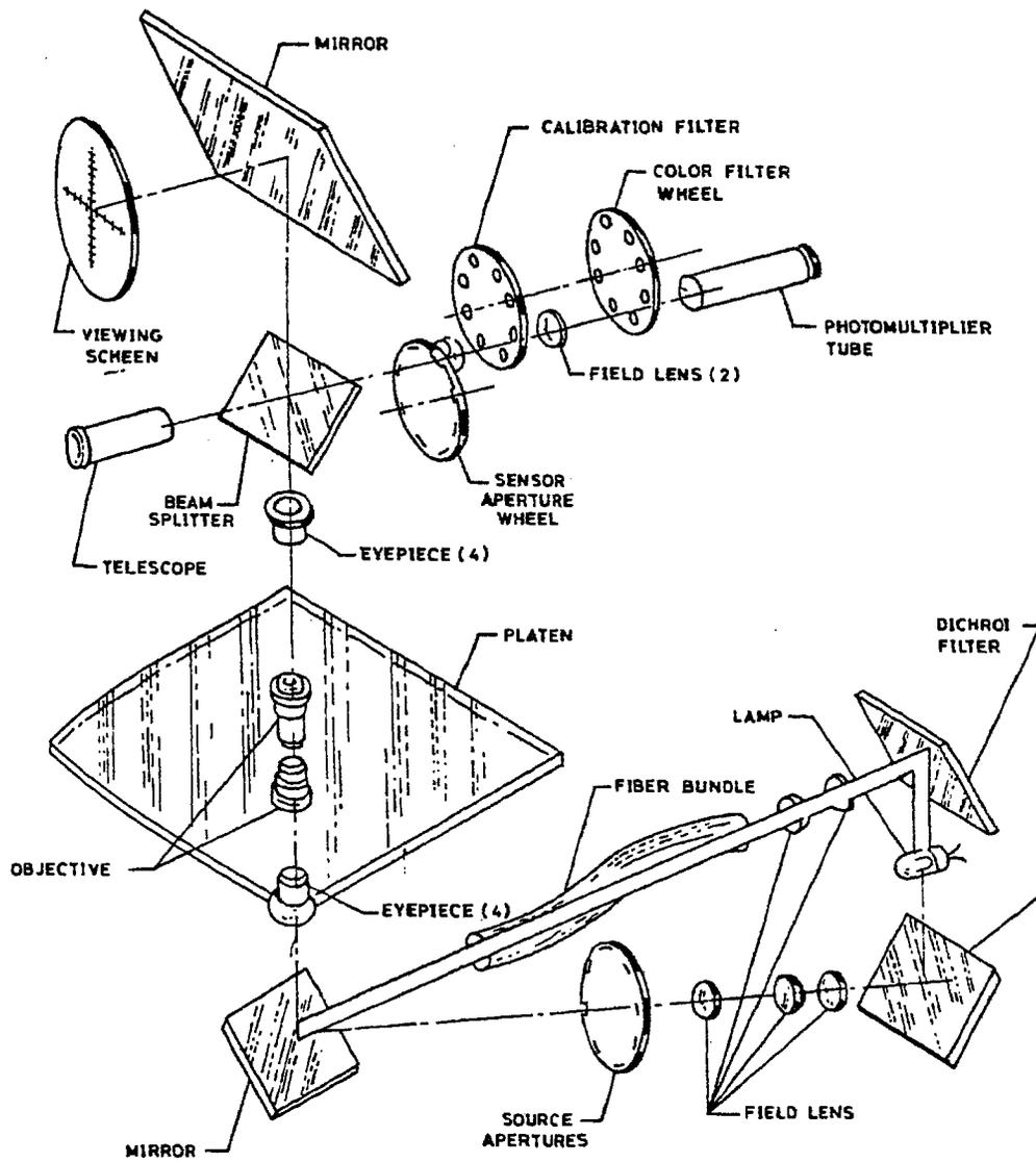
**FIG2-LIGHT PATH IN FULL FIELD POSITION**
